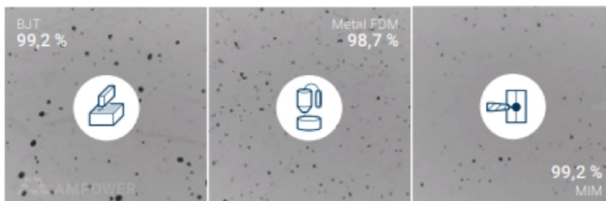
Porosidad de pieza sinterizada según la tecnología de fabricación (fuente: AMPOWER)
